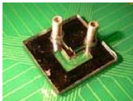
図 4: CMOS チップ搭載マイクロリアクタ
