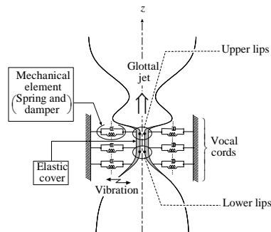
図2 声帯の機械モデル。
