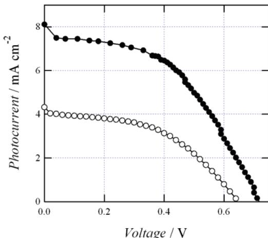
図4、 $\text{TiO}_2$  色素増感型太陽電池のIV特性。黒丸がP25ナノ粒子、白丸が中空球の場合。
