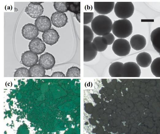
図 3、 $\text{Fe}_3\text{O}_4$  中空球の TEM(a)と写真(c)、 $\text{Fe}_3\text{O}_4$  粒子の TEM(b)と写真(d)
