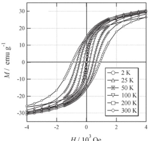
図 1、 $\text{Fe}_3\text{O}_4$  中空球の磁化曲線の温度依存性
