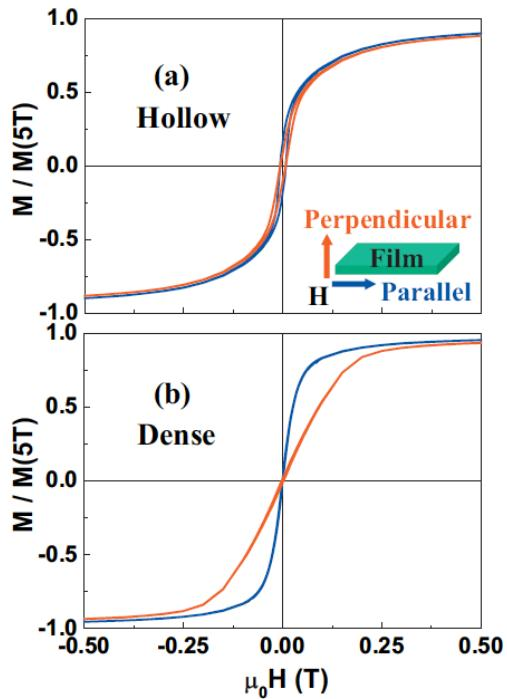
図 2、 $\text{Fe}_3\text{O}_4$  中空球(a)および粒子(b)薄膜の磁化曲線(磁場方向依存性)
