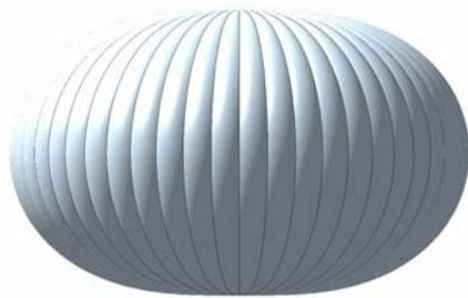
図 7. 次世代型圧力気球の膨張時形状
