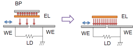
図1 発明した自立エレクトレット膜構造（左側：従来構造、右側：発明した構造）
