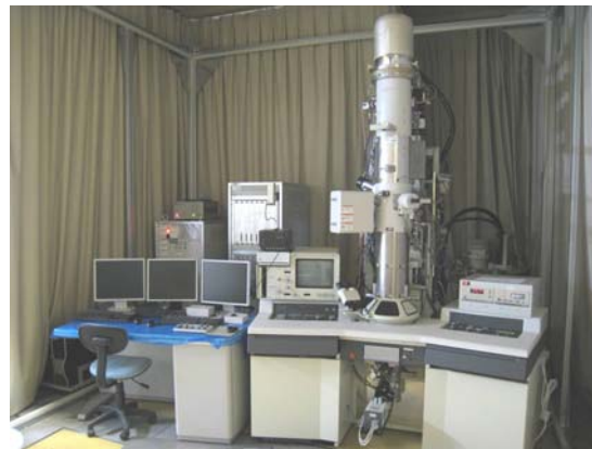
Fig. 7 新開発の STEM 鏡体(HD-2300S)
