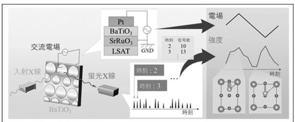
図4:チタン酸バリウム薄膜に交流電場をかけながら、同時に X 線を照射して、リアルタイムに電子状態(原子同士の結合の様子)を観察する実験の模式図
