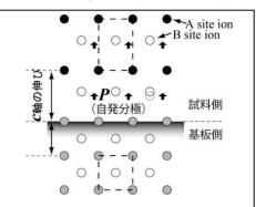
図 1 原子スケールでのクランプ 効果の説明図。この図では、圧縮 歪みによって自発分極(*P*)が増大 している。
