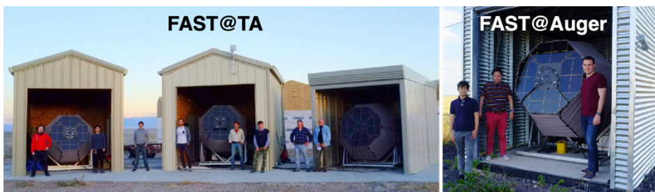
図 1 TA と Auger に設置した合計 4 基の新型大気蛍光望遠鏡
