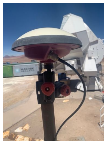
図 5 Simons Array の実験サイトに導入された GNSS のアンテナ。
