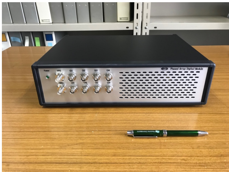
図1 本研究で開発したデジタルフェーズドアレイ装置のプロトタイプ
