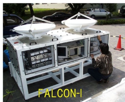
図 3. W バンドミリ波雲レーダ FALCON-I。
