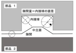
の任意の点の隙間量は、その点から最も近い中立面上の点の直径として定義する。以上が隙間量 を計測する基本となる。
