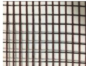
(b) X-Y軸が独立しているネット状補強材(欧米)
