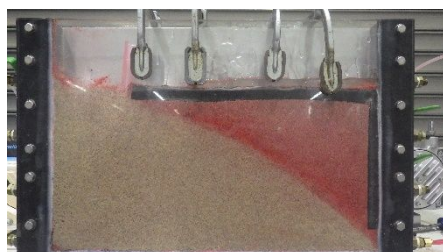
写真-3 間隙内二液反応発泡法を加えた結果
