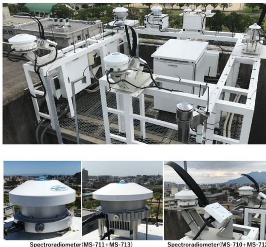
図 1 波長別日射量測定システム
