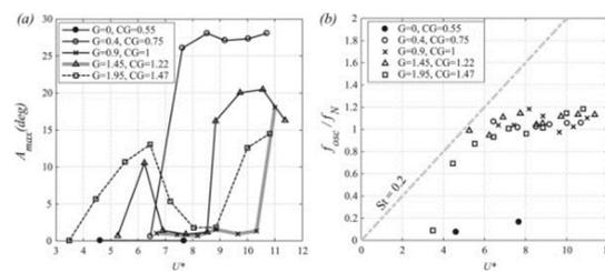
図4.実験結果。(左): 流速(無次元値)と振動振幅(角度)との関係、(右): 流速(無次元値)と振動数との関係。
