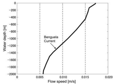
図6.ベンゲラ海流の流速鉛直分布。
