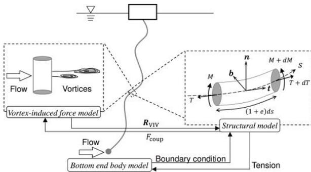
図5.海流速鉛直プロファイリングシステムの模式図。矢印は、水中線上構造物まわりの流れがおよぼす流体力モデル、構造モデル、下端重りのモデルの関係を表す。
