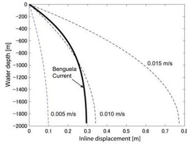
図7.水中線状構造物の変位（流れと同じ方向の成分）。破線：鉛直に一樣な流速分布を与えた場合、実線：ベンゲラ海流の鉛直分布（図6）を与えた場合。
