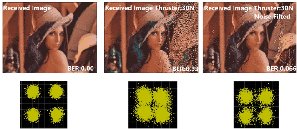
図5 超音波画像伝送実験の結果：左からスラスタノイズなし，ノイズ有り，ノイズフィルタ後の受信画像．下は受信信号の位相でありノイズがない場合は4つの象限に分類できている．
