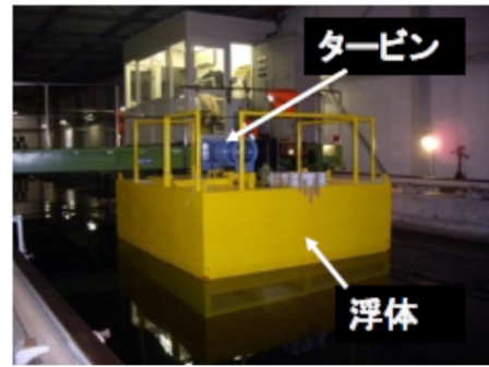
図5 浮体式振動水柱型波力発電装置 (BBDB)
