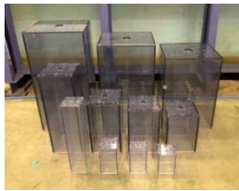
図1 底面開口箱型空気室模型
