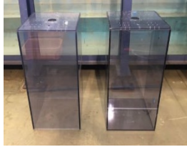
図2 前面開口箱型空気室模型
