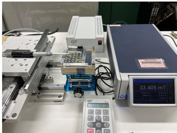
図6 測定系. XY ステージによりホール素子を移動させて磁束密度を測定した.
