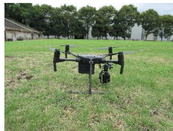
図2：サーモカメラ Zenmuse TX2 搭載の DJI M200 : (左) 組み立て後、(右) 計測地点
