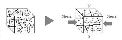
と断層面近傍で応力が変化するためピエゾ磁気効果により震源近傍で磁場変化が発生する。 この岩石中の磁気変化を捕らえるために,地磁気観測用の磁力計が必要となる。本研究では高温 超電導 SQUID 磁力計と TMR アレイ磁力計を検討する。
