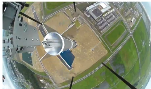
図7：ペネトレータ投下用ドローンからペネトレータを切り離した瞬間（対地高度150m）
