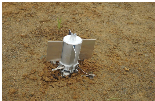
図 4：貫入緩和装置を用いてペネトレータ投下試験を行った時の状況
