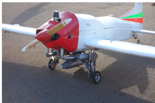
図 2：ペネトレータを搭載した有翼無人航空機
