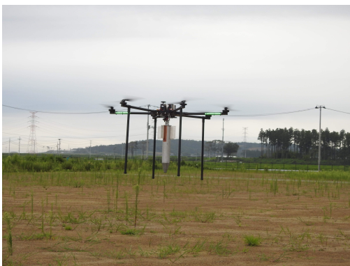
図6：ペネトレータを搭載した回転翼ドローン
