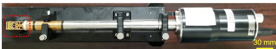
図 1 . 本研究で開発された光誘起・電場印加電子顕微鏡ホルダーの写真
