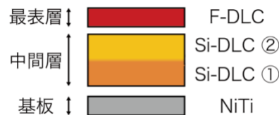
図2 本研究におけるNiTiステント上への無機コーティング
