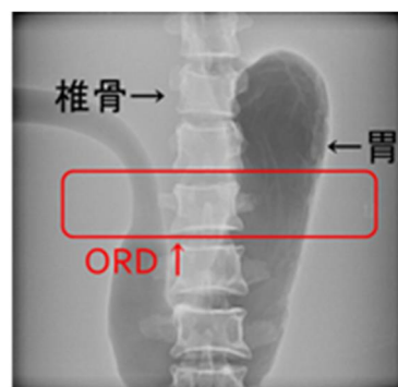
図-6 腹部ファントム上に素子を置いた場合の透過像 (赤枠内に素子がある)
