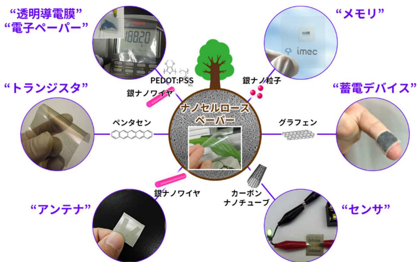
図1 これまでの研究成果：樹木ナノセルロースと電子ナノ材料を複合化したペーパー電子デバイス「ペーパーエレクトロニクス」
