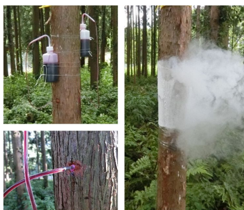
図1 立木へのセシウム溶液注入と液体窒素を用いた立木凍結固定伐採法
