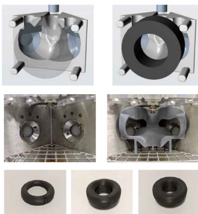
図 2: インサートパーツの 3D モデルと実際に成形したインサートパーツ類
