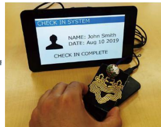
図6 左：漆NFCの配線例 右：試作したアプリケーション
