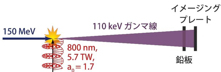
図3: 関西研で行った円偏光レーザーを用いた非線形逆コンプトン散乱実験の概要。
