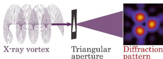
図4: 三角開口を用いたX線渦のらせん波面測定の概要。
