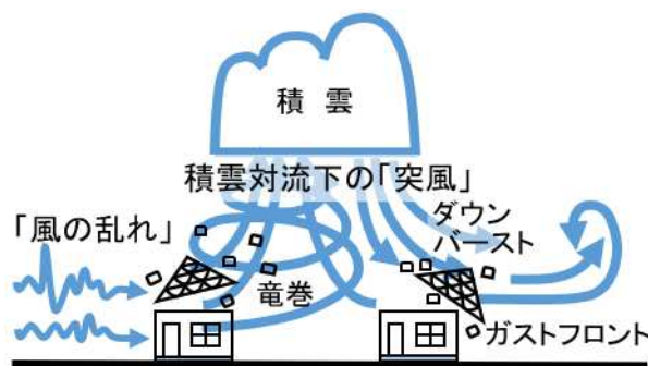
図1 建物被害を引き起こす強風の原因
