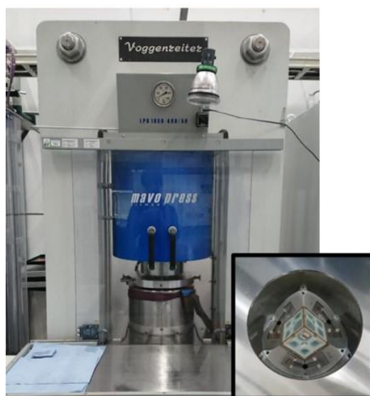
図 3. マルチアンビル型高温高压発生装置。右下図は加圧後のアンビル集合体。
