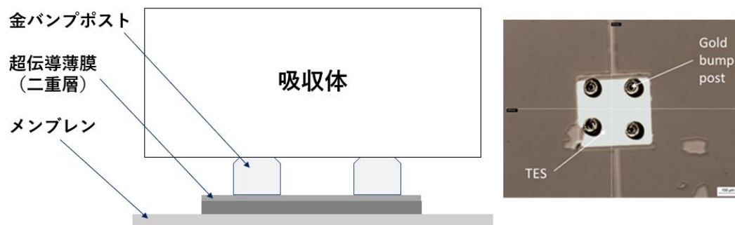
図 1: TES の構造の概略図と試作した TES。左)メンブレン上に積膜された超伝導薄膜に金のバンプポストが形成され、吸収体が搭載される。右)イリジウム金の超伝導薄膜に金のバンプポストを 4 つ形成。
