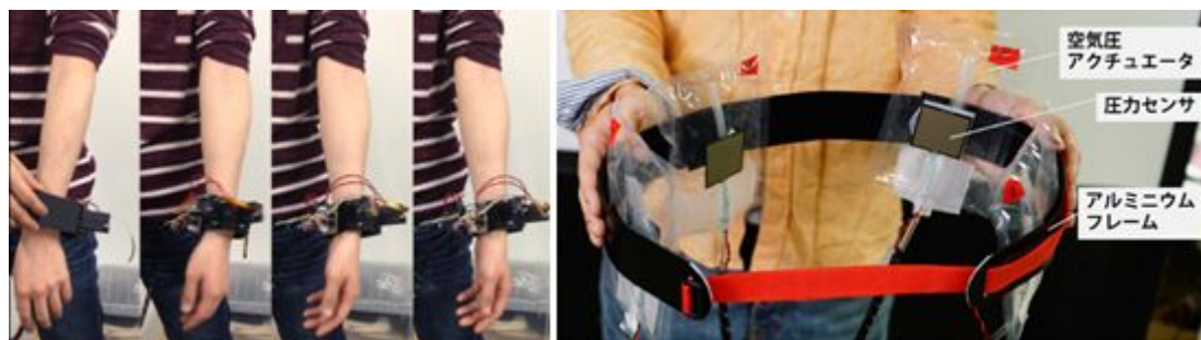
図 1 皮膚せん断変形ユニット。(左)手首用(右)胸部用空気圧駆動タイプ
