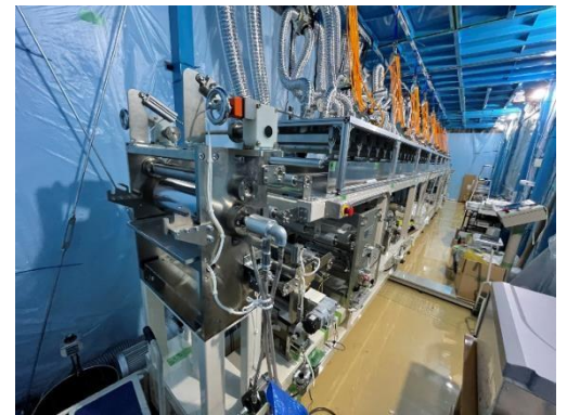
図2 開発した原子核乾板専用 RtR 塗布装置
