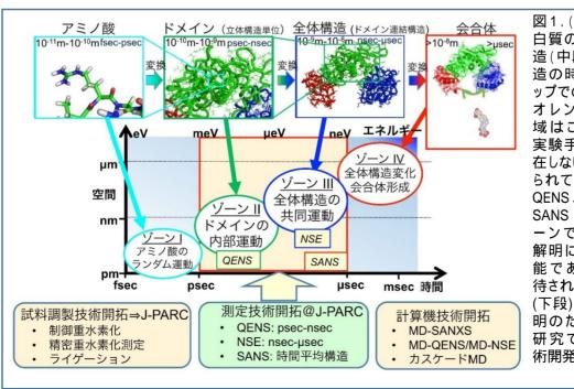
図1.(上段)蛋 白質の階層構 造(中段)各構 造の時空間マ ップでの分布。 オレンジの領 域はこれまで 実験手法が存 在しないと考え られてきたが、 QENS, NSE, SANS が各ゾ -ンでの運動 解明に適用可 能であると期 待されている。 (下段) 運動解 明のために本 研究で行う技 術開発群。
