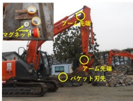
図7 角度センサー（3基）取り付け
