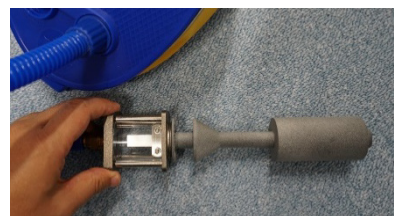
図 6：空気ポンプと新しいリード式音源 (模型は VTM-T20-O)
