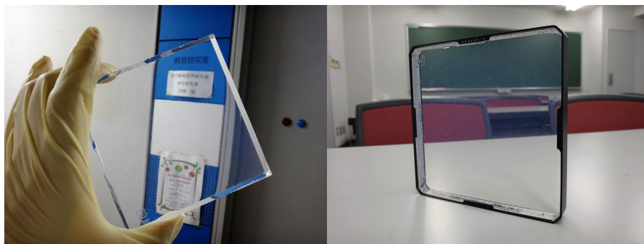
図1 (左) 実機用に量産したエアロゲルのサンプル (参考文献[1]より)。(右) 切断加工後、アルミフレームに接着したエアロゲル (参考文献[2]より)。
