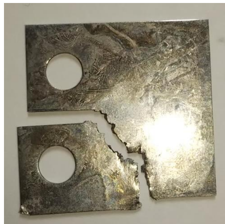
図 4 過大荷重疲労試験での C(T) 試験片のき裂成長経路
