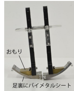
図1 熱歩行機構 (高さ約17cm)
