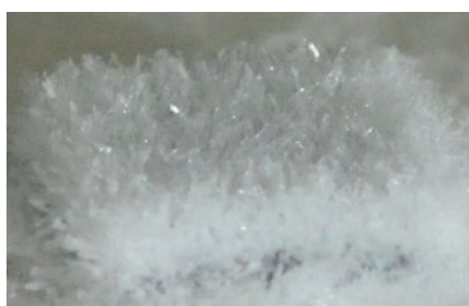
図2 着霜時の写真(親水面) t=900 秒後
