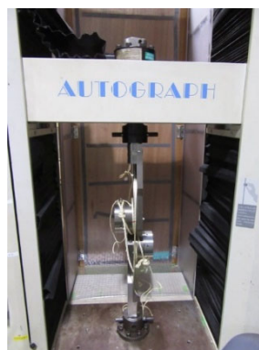
図 11 新規開発治具による引張強度測定
