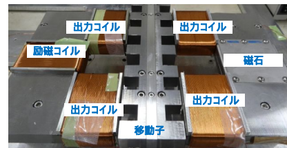
図6 2種磁束並進構造リニアジェネレータ
