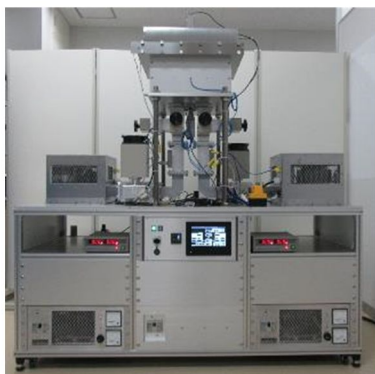
図 3 300 mm 試料加熱装置概念図
