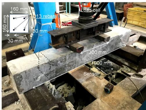
図-1 混和材を用いたRCはりの曲げ疲労実験
