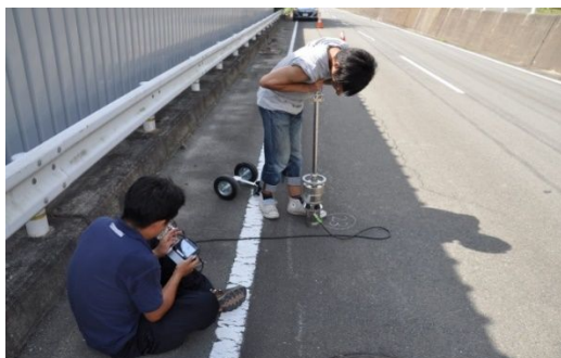
写真-1 小型FWDによる支持力調査
