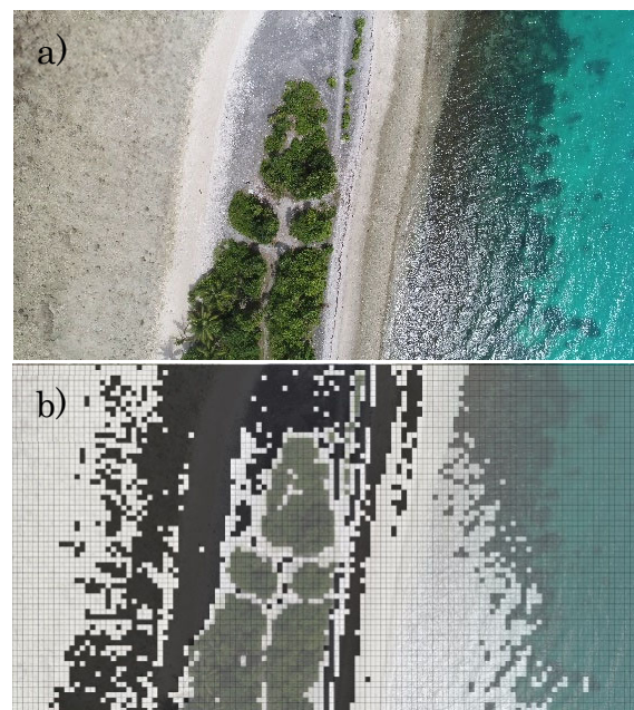
図-9 中間層 3 層モデルでの砂域の分類結果 (入力画像 64×64, 畳み込み枚数 32, 64, 128, 畳み込みサイズ 2×2, バッチ数 40) a) 原画像, b) モザイク処理なしの学習モデルの分類画像, (黒色が砂, 白色が礫, 半透明がその他を示す.)
