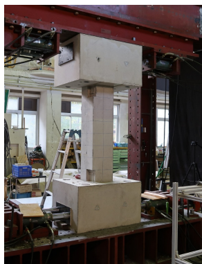
図 2 柱の加力実験
