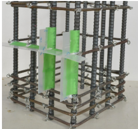
図 5 鉄筋腐食ひび割れの模擬
