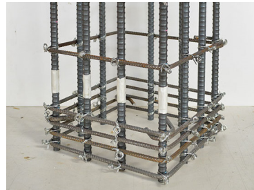
図 7 鉄筋腐食の模擬
