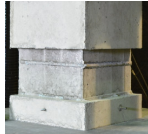
図 6 コンクリートの浮き・剥離の模擬
