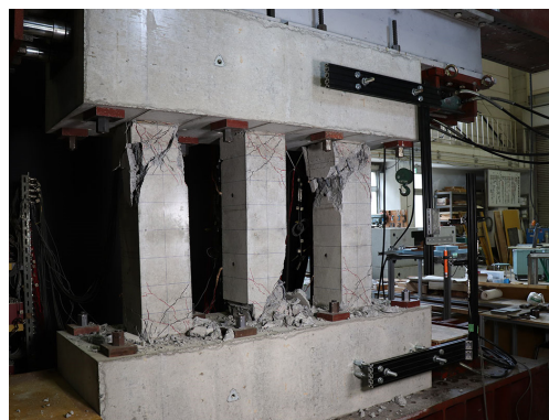
図 3 RC 柱群の加力実験
